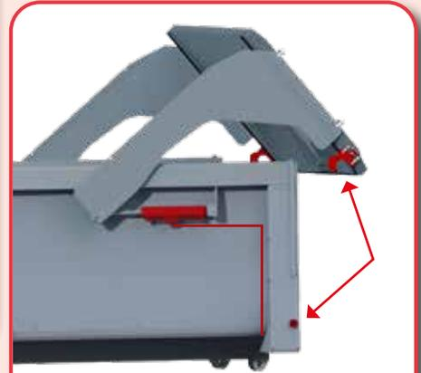
**Öffnungszyylinder der Heckklappe**, die durch den Türarm und den oberen Kastenrahmen geschützt sind.
